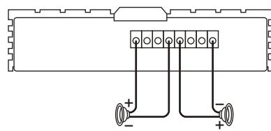
2 канала + 1 канал (мостовой режим)
