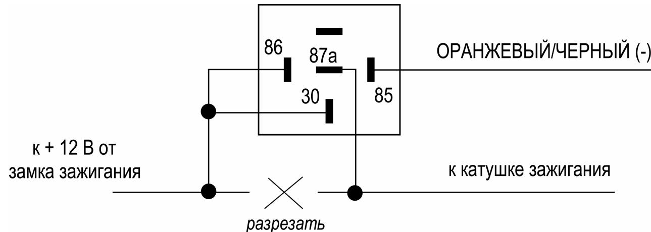
**Примечание:** данная схема может также использоваться для подключения Синего провода системы, для этого Синий провод должен быть запрограммирован как «отрицательный выход при включенном режиме охраны для управления дополнительным Н.З. реле блокировки двигателя» (программируемая функция # 15).
